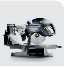
Langsam drehende Kappsäge mit fein- gezahntem Sägeblatt (mind. 80 Zähne) für Aluminium
