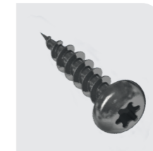
4 Schraube 3,5 mm x 16 mm (T15) zur Befestigung Längsverbinder
